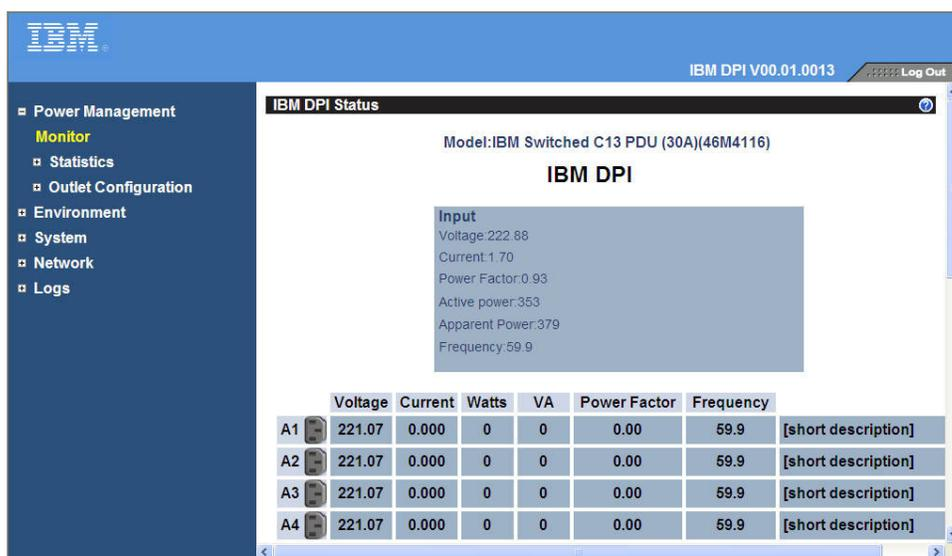
メインページには、PDU 電源コンセントのグラフィカル表示と入力状況が、次のように表示されます。
