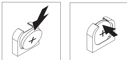
图 191. 安装系统电池
