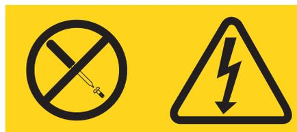
Qualquer componente que contenha esta etiqueta possui voltagem, correntes e níveis de energia perigosos. Não existem peças que podem ser consertadas no interior do dispositivo. Se você suspeitar de um problema com alguma dessas peças, entre em contato com um técnico.
