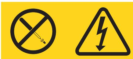
Nei componenti con questa etichetta potrebbero essere presenti livelli di energia, corrente e tensione rischiosi. All'interno di questi componenti non sono presenti parti soggette a manutenzione. Se si sospetta la presenza di un problema in una di queste parti, rivolgersi ad un tecnico dell'assistenza IBM.
