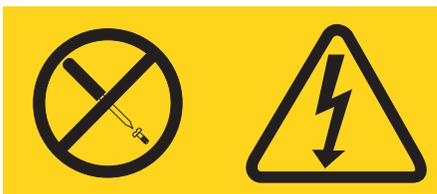
Qualquer componente que tiver esta etiqueta possui voltagem, correntes e níveis de energia perigosos. Nenhuma peça no interior do dispositivo poderá ser consertada. Se você suspeitar de um problema com alguma dessas peças, entre em contato com um técnico.
