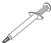
註：0.01 毫升是針筒上的一個刻度標記。如果正確塗抹散熱膏，針筒中會剩下約一半的散熱膏（0.22 毫升）。
