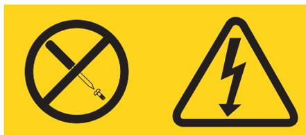
Voltagem, corrente e níveis de energia perigosos estão presentes dentro de qualquer componente que tenha esta etiqueta. Não existem peças no interior desses componentes que possam ser consertadas. Se o Cliente suspeitar de algum problema com uma dessas peças, deve entrar em contato com um técnico de serviço.
