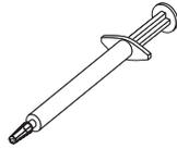
**Anmerkung:** 0,01 ml entspricht einem Teilstrich an der Spritze. Nach dem ordnungsgemäßen Auftragen der Paste enthält die Spritze noch etwa die Hälfte (0,22 ml) der Paste.
