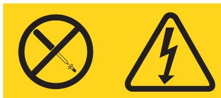
Livelli di tensione, corrente ed energia pericolosi sono presenti all'interno dei componenti a cui è attaccata questa etichetta. All'interno di queste unità non sono presenti parti soggette a manutenzione. Se si sospetta la presenza di un problema in una di queste unità, rivolgersi ad un tecnico di assistenza.
