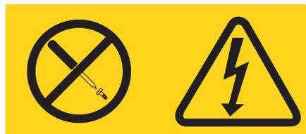
Los componentes con esta etiqueta tienen en el interior niveles de voltaje, corriente y energía que resultan peligrosos. Dentro de estos componentes no hay ninguna pieza que requiera mantenimiento. Si sospecha de la existencia de algún problema en una de estas piezas, póngase en contacto con el servicio técnico.
