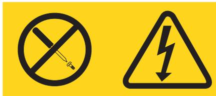
Los componentes con este tipo de etiquetas tienen en el interior un nivel de voltaje, de corriente y de energía peligrosos. Estos componentes no tienen piezas que puedan repararse. Si sospecha de la existencia de algún problema en una de estas piezas, póngase en contacto con un técnico de servicio.
