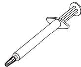
**注:** 注射器の 1 目盛りが 0.01 ML です。グリースを正しく使用すると、注射器に約半分のグリース (0.22 ML) が残ります。
