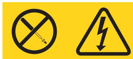
All'interno di ogni unità su cui è apposta sono presenti tensioni, livelli di corrente e di energia pericolosi. All'interno di questi componenti non sono presenti parti soggette a manutenzione. Se si sospetta la presenza di un problema in una di queste unità, rivolgersi ad un tecnico di assistenza.
