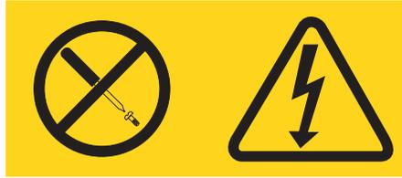
Los niveles de energía, de voltaje peligroso y de la corriente están presentes dentro de cualquier componente que tenga esta etiqueta adjunta. No hay componentes resistentes dentro de estos componentes. Si sospecha que hay un problema con uno de estos componentes, póngase en contacto con un técnico de servicio.
