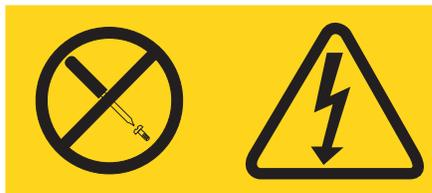
任何贴有该标签的组件内都有危险的电压、电流和能量级别。这些组件内部没有可维护的部件。如果您怀疑某个部件有问题，请联系技术服务人员。
