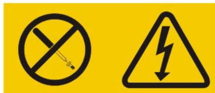
Níveis de energia, corrente e voltagem perigosos estão presentes dentro de qualquer componente que tenha essa etiqueta anexada. Nenhuma peça localizada no interior desses componentes pode ser consertada. Se você suspeitar de um problema com uma dessas peças, entre em contato com um técnico de manutenção.
