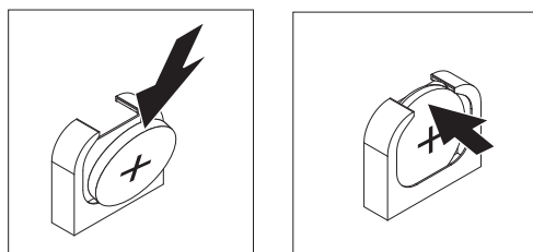
図 93. バッテリーの取り付け
