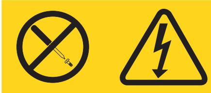
Voltagens, correntes e níveis de energia perigosos estão presentes dentro de qualquer componente que tenha esta etiqueta. Não há peças que possam ser consertadas no interior desses componentes. Se você suspeitar de um problema com alguma dessas peças, entre em contato com um técnico.
