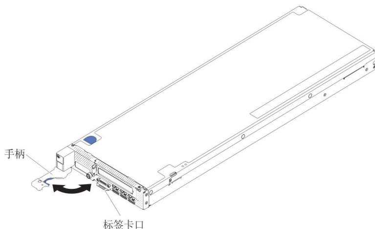
图 12. 在 IBM NeXtScale n1200 机柜中安装计算节点
