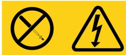
贴有此标签的任何组件中存在危险的电压、电流和能级。这些组件内没有可维护的部件。如果怀疑这些部件中的某一个有问题，请联系技术服务人员。
