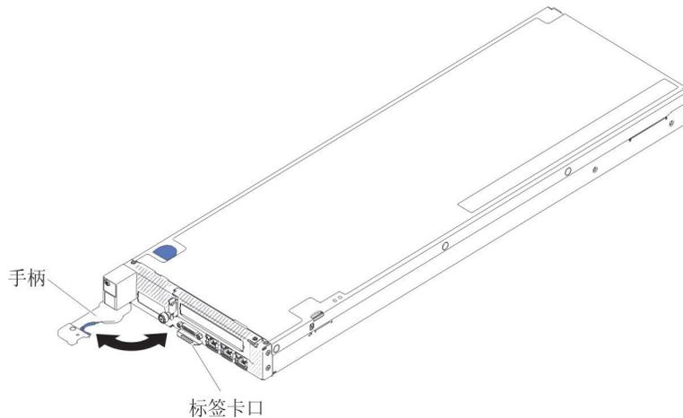
图 11. 从机箱卸下 NeXtScale nx360 M4 计算节点刀片服务器
