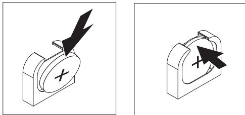
図 44. システム・バッテリーの取り付け
