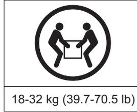
**Este componente o unidad tiene un peso entre 18 y 32 kg. (39,7 y 70,5 libras). Se necesitan dos personas para levantar, de manera segura, este componente o unidad. (C009)**
