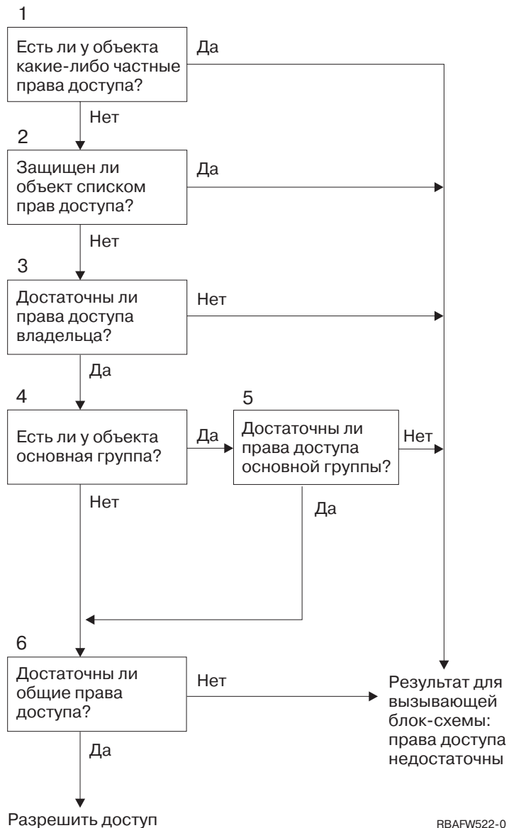
Рисунок 12. Блок-схема 2: Быстрая проверка прав доступа к объекту
