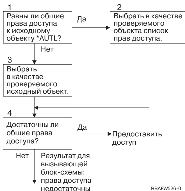
Рисунок 17. Блок-схема 7: Проверка общих прав доступа
