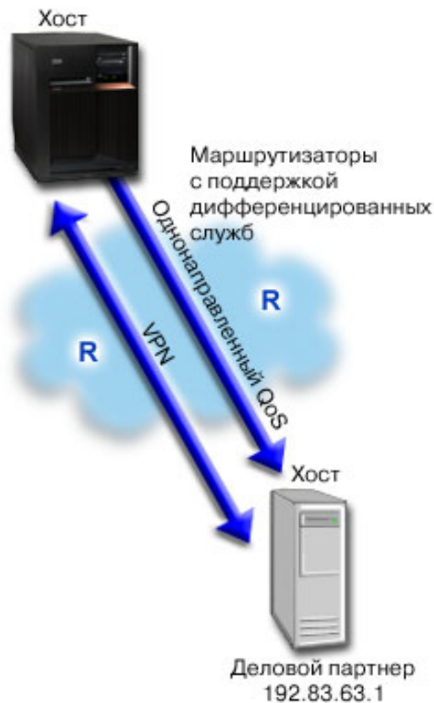
Рисунок 5. Соединение VPN между хостами, использующее стратегию дифференцированного обслуживания QoS.
