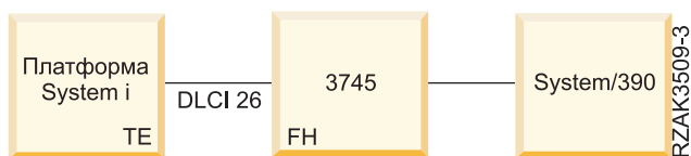
Рисунок 19. Прямое соединение SNA с 3745 Host Controller
