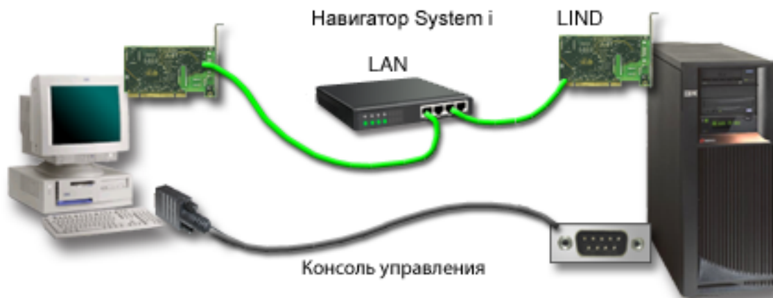
Рисунок 2. Конфигурация с отдельным подключением System i Navigator и Консоли управления
