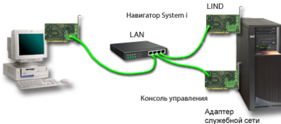
Рисунок 3. Конфигурация с совместным подключением System i Navigator и Консоли управления через одну сеть
