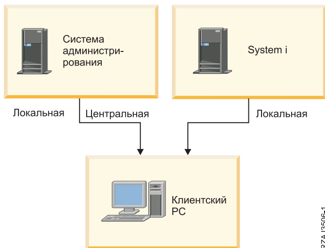
Рисунок 1. При подключении клиентского PC к системе Локальные параметры загружаются из этой системы. Общие параметры передаются на клиентский PC из управляющей системы.
