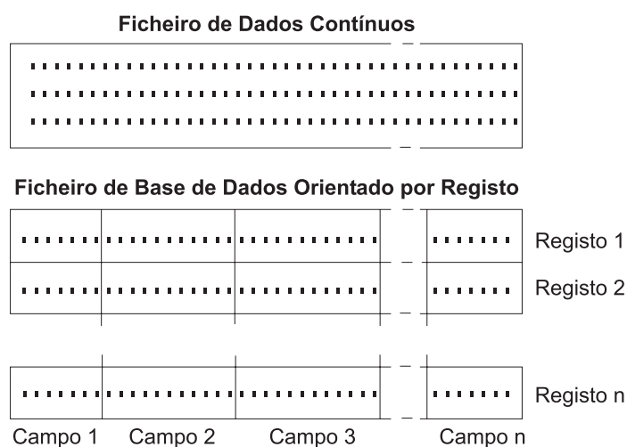
Figura 7. Comparação de um ficheiro de dados contínuos com um ficheiro orientado para registos
