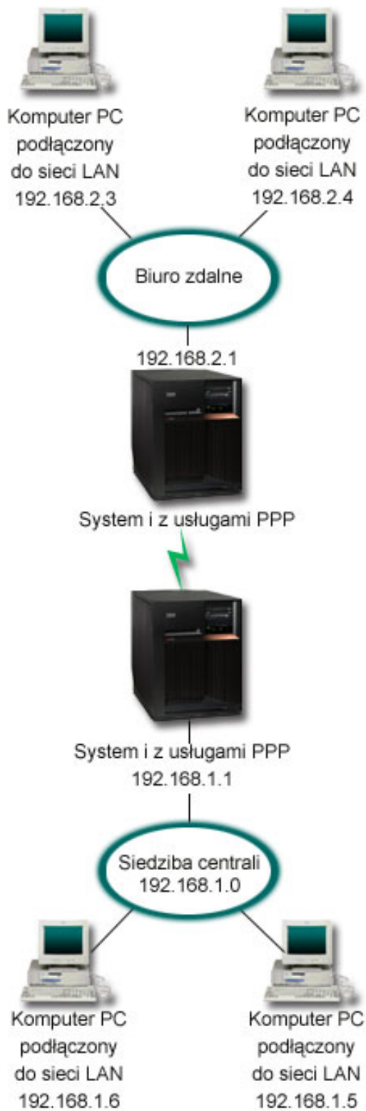
Rysunek 6. Łączenie sieci korporacyjnej z sieciami zdalnymi za pomocą modemu
