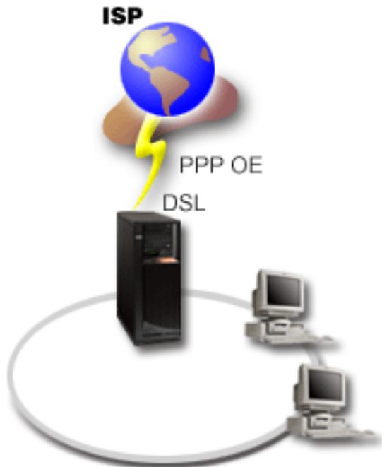
Rysunek 3. Połączenie systemu z dostawcą ISP przy użyciu PPPoE
