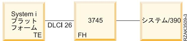
図 19. 3745 ホスト制御装置への SNA 直接接続
