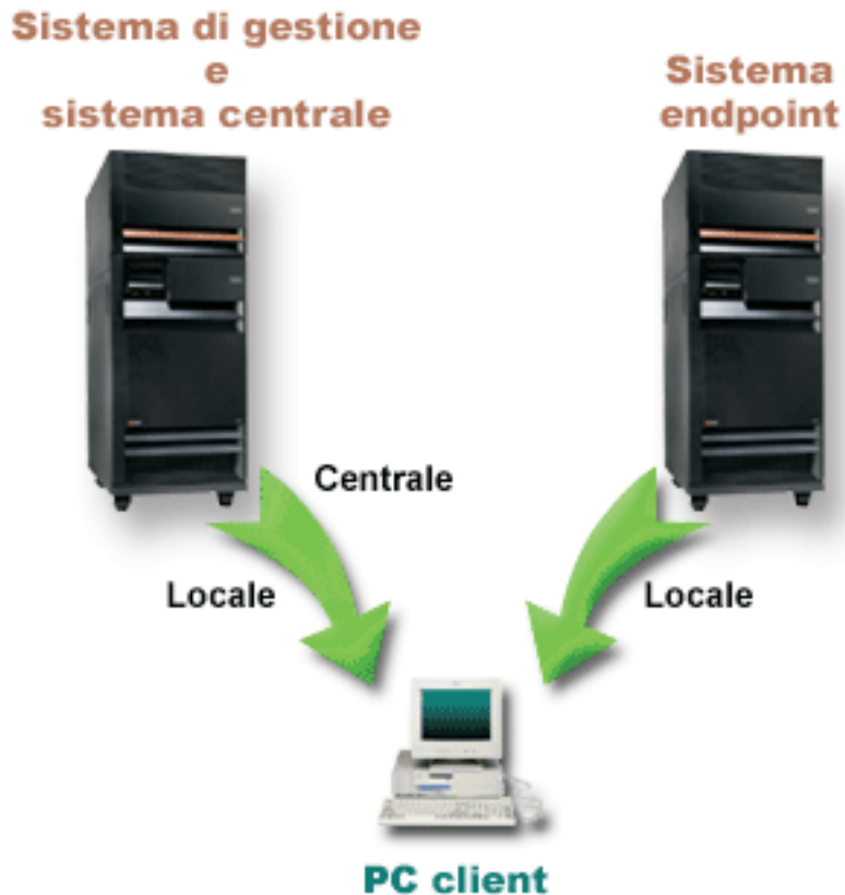
Figura 3. Il sistema di gestione e il sistema centrale possono essere lo stesso sistema. Esso non modifica la funzione di Gestione applicazioni e di Management Central. Quando un PC client si collega ad un sistema, le Impostazioni locali vengono dal sistema a cui ci si collega. Quando si effettua il collegamento ad un sistema di gestione, le Impostazioni centrali vengono inviate al proprio PC client dal sistema di gestione.
