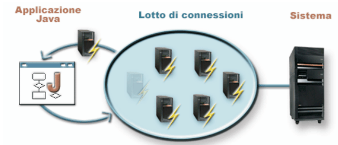
Figura 3: esempio di programma Java che richiama un collegamento da AS400ConnectionPool ad un server
