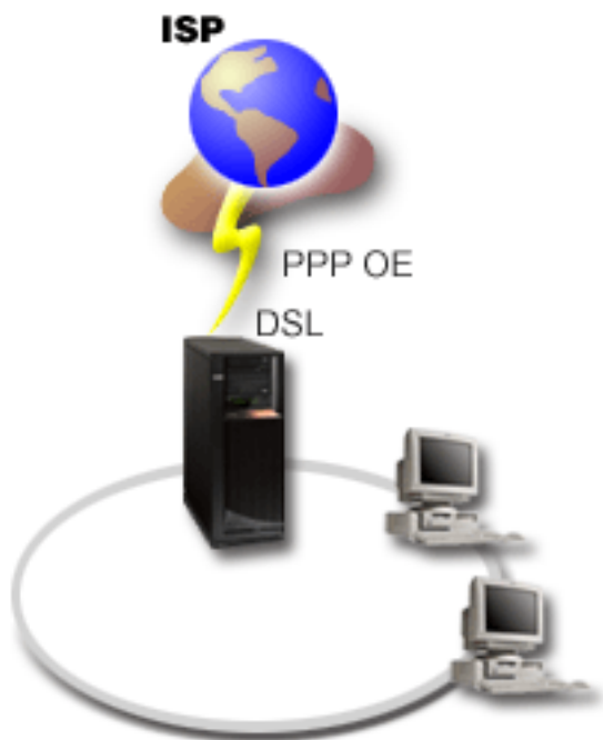
3. ábra: Rendszer csatlakoztatása Internet szolgáltatóhoz PPPoE segítségével
