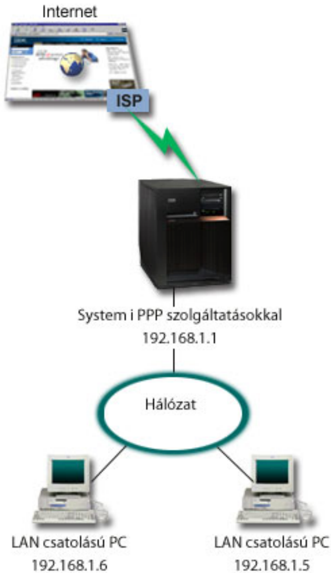
5. ábra: Irodai LAN csatlakoztatása az Internethez modem segítségével
