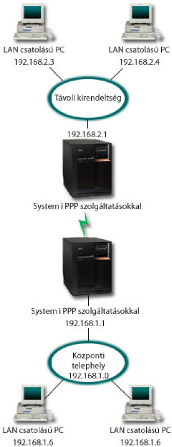
6. ábra: Vállalati és távoli hálózatok összekapcsolása modemmel
