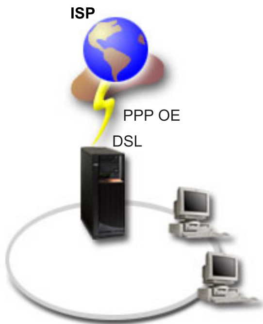
Slika 3. Spajanje vašeg sistema na ISP sa PPPoE
