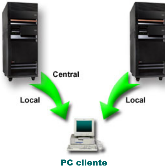
Figura 3. El sistema de administración y el sistema central pueden ser el mismo sistema. Ello no cambia la función de Administración de Aplicaciones ni de Management Central. Cuando un PC cliente se conecta a un sistema, los valores locales proceden del sistema al que se haya conectado. Si usted se conecta a un sistema de administración, los valores centrales se envían desde el sistema de administración a su PC cliente.
