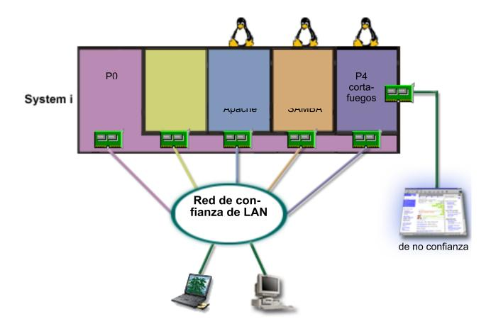
En el servidor había recursos que le permitieron crear otra partición huésped mediante System i Navigator. Ha instalado Linux en la partición P4. El cortafuegos está incorporado al kernel que está utilizando. La partición de cortafuegos Linux es propietaria de un adaptador LAN de conexión directa que protege todo el sistema contra datos que no son de confianza.
