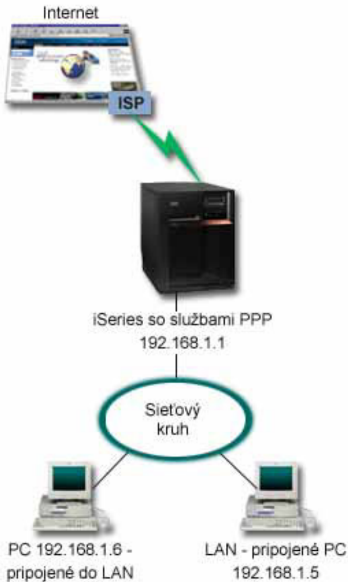
Obrázok 5. Pripojenie kancelárskej LAN k Internetu cez modem
