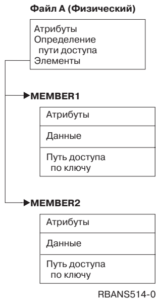
Рисунок 20. Пример файла базы данных, состоящего из двух элементов
