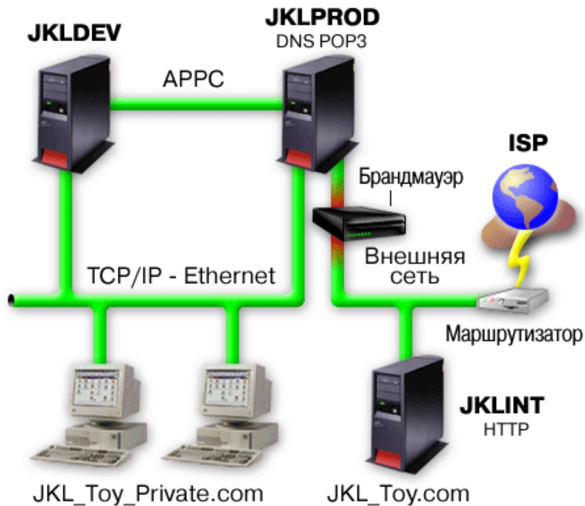
Как показано на рисунке, в фирме JKL Toys используются две основные системы iSeries. Одна из них (JKLDEV) применяется для разработки программ, а вторая (JKLPROM) - в производственных целях. Обе системы работают с крайне важными данными и программами. Поэтому фирма JKL решила, что на этих системах нельзя устанавливать программное обеспечение, которое будет взаимодействовать с Internet. Для этих целей было решено приобрести еще одну систему iSeries (JKLINT).
