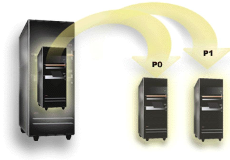
Логические разделы позволяют работать с сервером iSeries, как с несколькими независимыми серверами. Каждый логический раздел представляет независимый логический сервер. Однако все разделы применяют некоторые общие атрибуты физической системы, такие как серийный номер системы, модель системы и код процессора. Остальные атрибуты разделов могут различаться.
