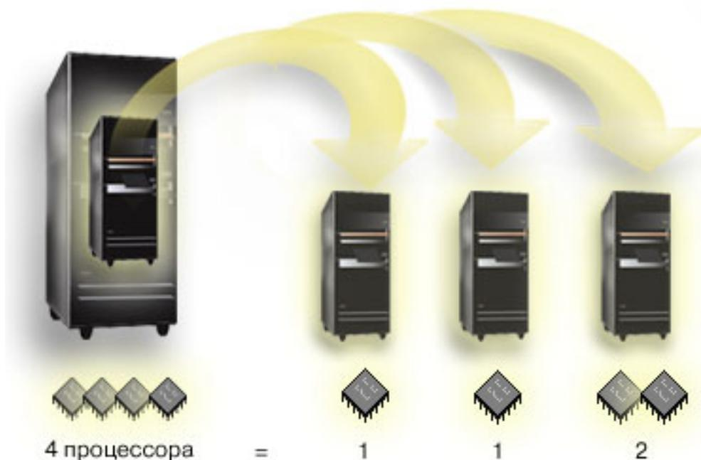
Например, сервер с 4 физическими процессорами можно разбить на 3 логических раздела, причем два раздела будут иметь по 1 выделенному процессору, а один раздел - 2 выделенных процессора.
