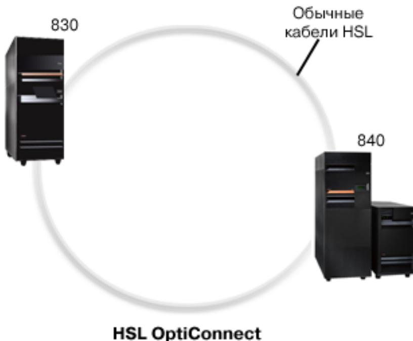
Высокоскоростной (HSL) OptiConnect обеспечивает быструю связь между системами на основе PCI. Для применения OptiConnect требуются обычные кабели HSL, и не нужно никакое дополнительное аппаратное обеспечение. Необходимо приобрести только программный продукт OptiConnect for i5/OS. Программное обеспечение OptiConnect выбирает виртуальный путь OptiConnect в HSL или внешний путь SPD OptiConnect, если доступно несколько путей.
