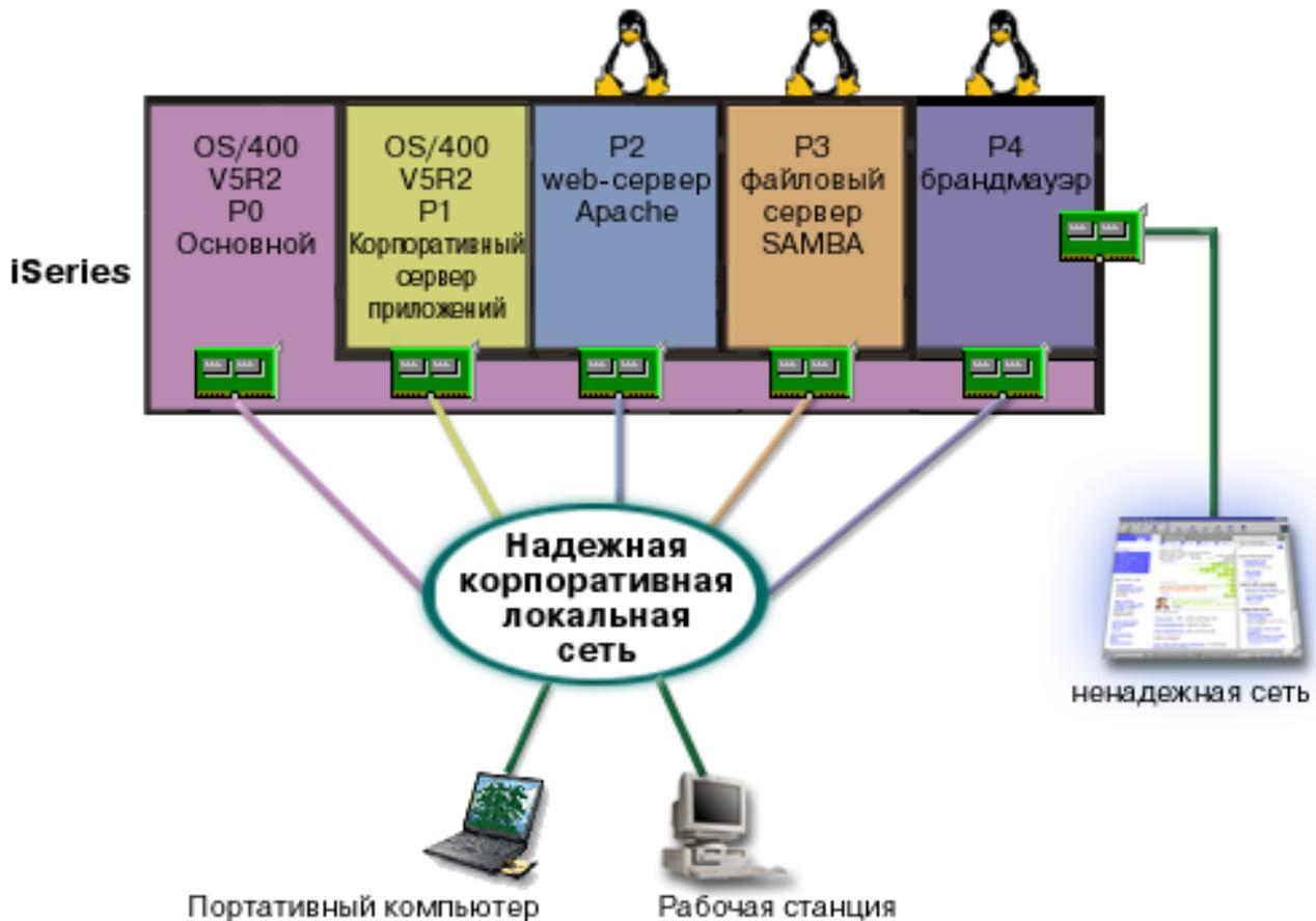
На сервере было достаточно аппаратных ресурсов для создания еще одного гостевого раздела с помощью Навигатора. В разделе P4 была установлена операционная система Linux. Брандмауэр встроен в применяемое ядро. Разделу брандмауэра Linux выделен подключенный напрямую сетевой адаптер, который обеспечивает защиту всей системы от непроверенных данных.
