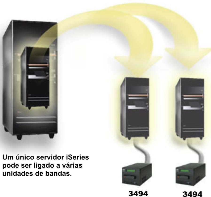
A figura que se segue mostra uma configuração não suportada. O cabo liga o servidor iSeries às unidades de bandas.
