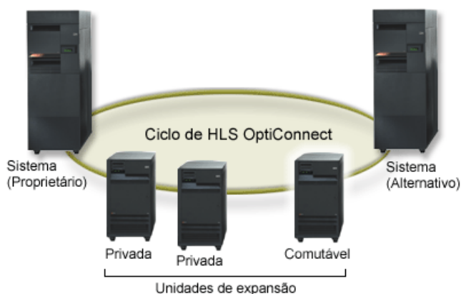
Figura 6. A unidade de expansão mais distante do servidor proprietário no segmento de ciclo foi tornada comutável.
