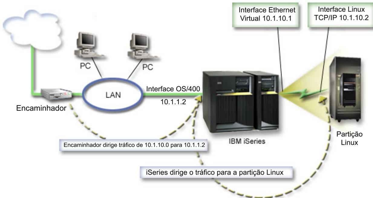
A interface de TCP/IP existente (10.1.1.2) liga à rede local. A rede local está ligada a redes remotas com um encaminhador. A interface de TCP/IP do Linux tem o endereço 10.1.10.2 e a interface de Ethernet TCP/IP de Ethernet virtual 10.1.10.1. No i5/OS, se ligar o Reencaminhamento de datagramas de IP, o iSeries irá encaminhar os pacotes de IP para e a partir da partição lógica. Quando definir a ligação de TCP/IP de Linux, o endereço do encaminhador deve ser 10.1.10.1.
