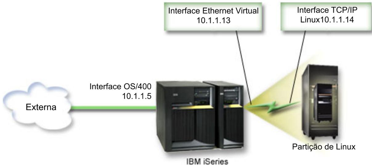
Neste exemplo, é utilizado um bloco contíguo de quatro endereços de IP, que consiste em 10.1.1.12 - 10.1.1.15. Visto tratar-se de um bloco de quatro endereços de IP, a máscara de sub-rede para estes endereços é 255.255.255.252. Para efectuar uma configuração semelhante a esta, utilize as seguintes instruções:
