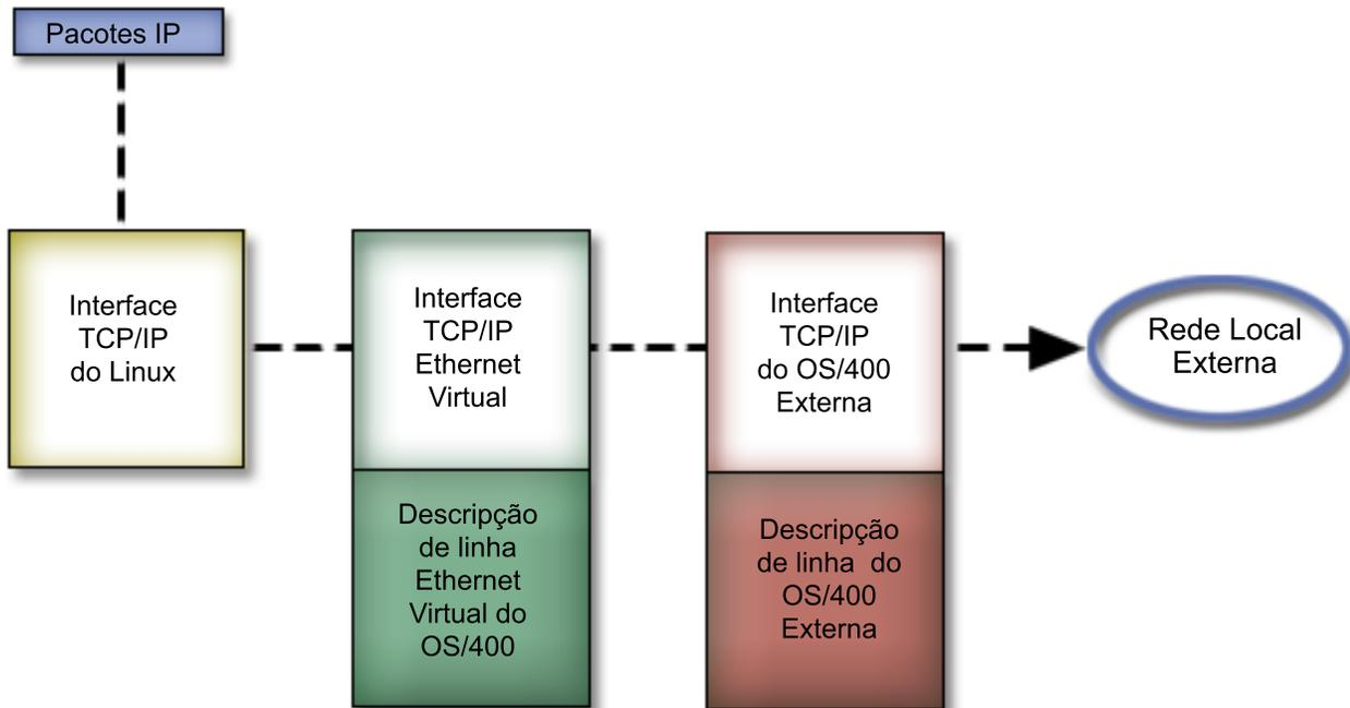
O tráfego IP iniciado pela partição lógica vai desde a interface de rede do Linux até à interface virtual do i5/OS. Se a interface virtual estiver associada à interface externa, os pacotes de IP podem prosseguir para a interface externa e para o seu destino.
