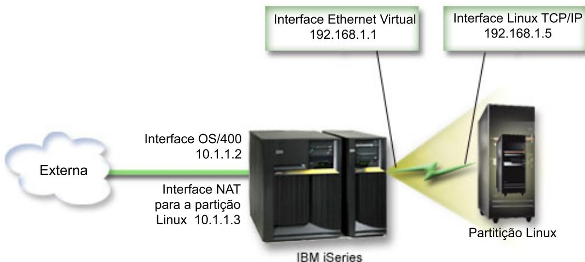
Neste exemplo, todo o tráfego de TCP/IP existente para a partição alojadora de iSeries passa pela interface 10.1.1.2. Visto este cenário ser de predefinições estáticas, o tráfego interno é convertido da interface 10.1.1.3 para a interface 192.168.1.1. O tráfego externo é convertido da interface 192.168.1.1 para a interface externa 10.1.1.3. A partição lógica utiliza a interface virtual (192.168.1.1) e a própria interface 192.168.1.5 para comunicar com o servidor.
