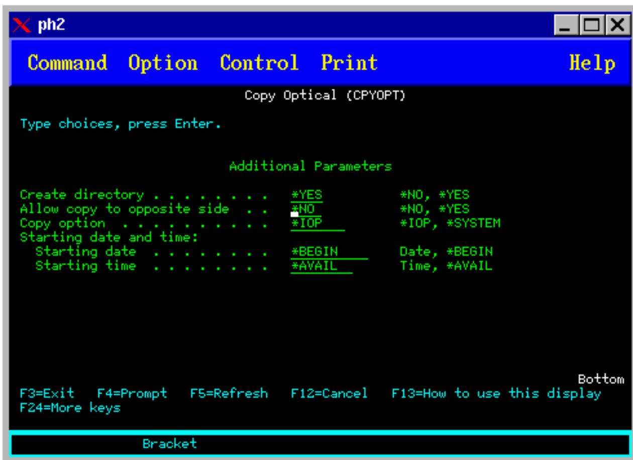
Este comando não é permitido para dispositivos óticos conectados à LAN. Se você tentar utilizar um dispositivo ótico conectado à LAN, uma mensagem de erro será emitida.
