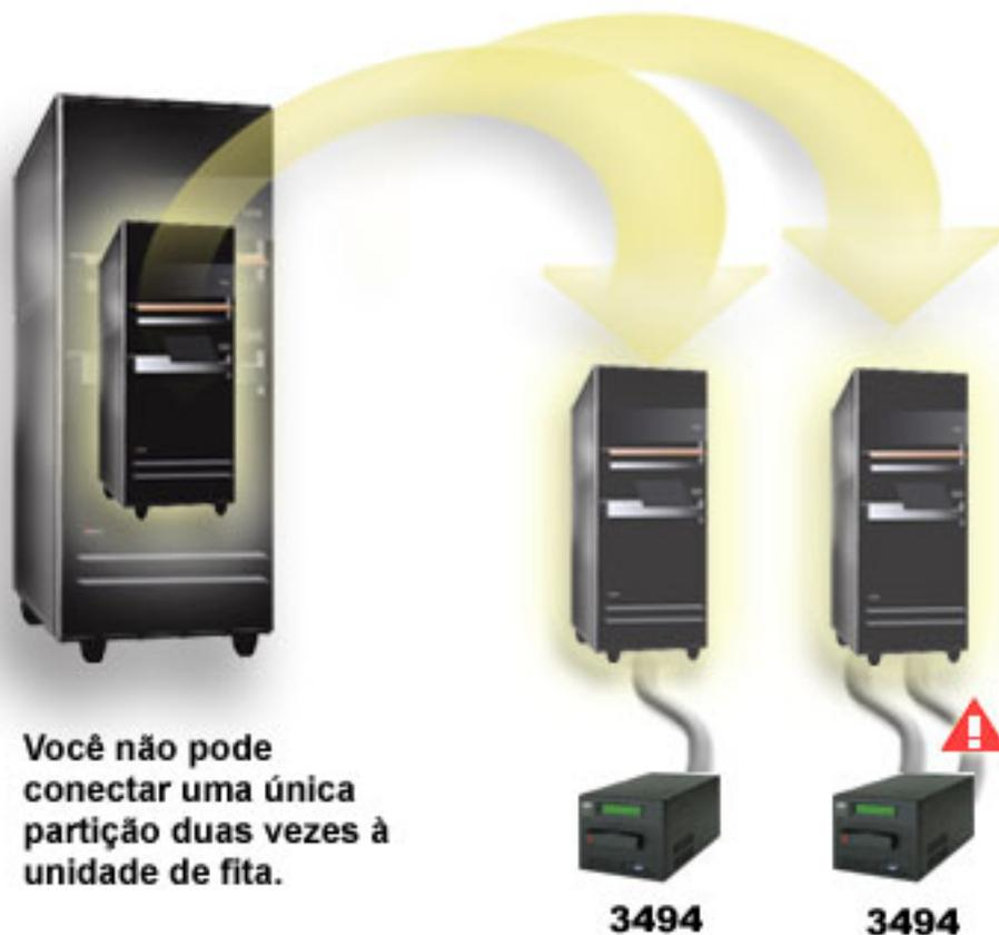
Figura 2. Configuração Não Suportada
