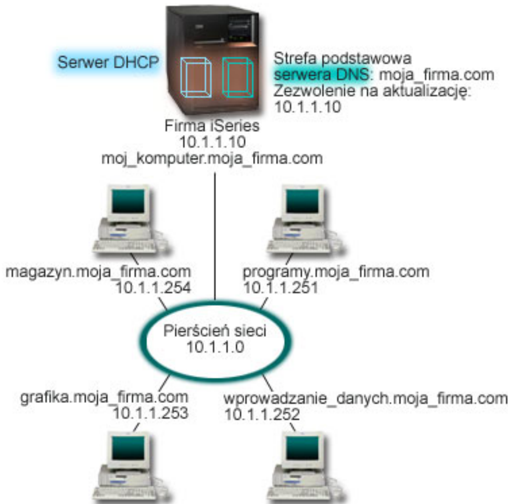
Rysunek 4. Serwery DNS i DHCP na tym samym serwerze iSeries.
