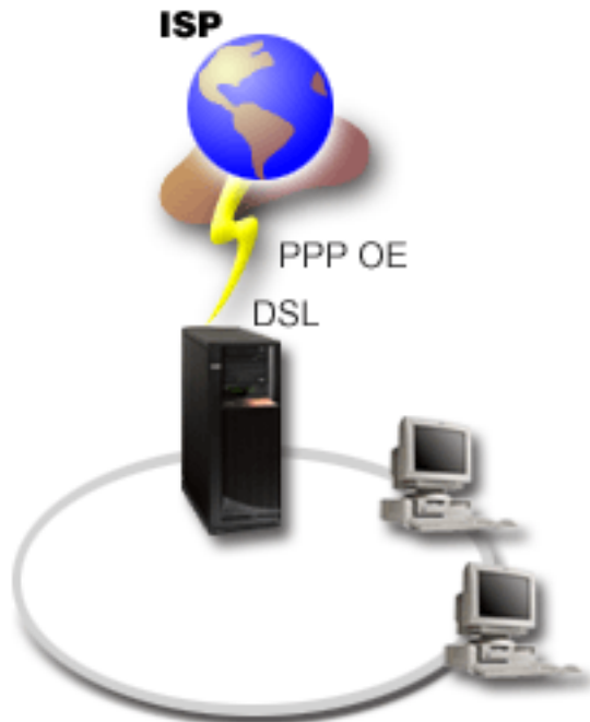
Rysunek 3. Połączenie serwera iSeries do dostawcy ISP przy użyciu PPPoE
