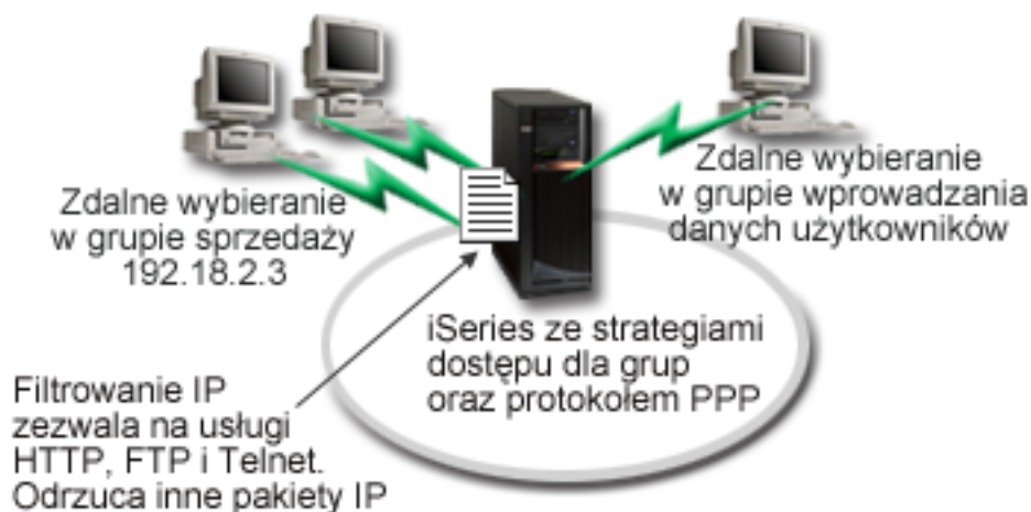
Rysunek 8. Zastosowanie ustawień połączenia do połączeń modemowych z wykorzystaniem ustawień strategii dla grupy
