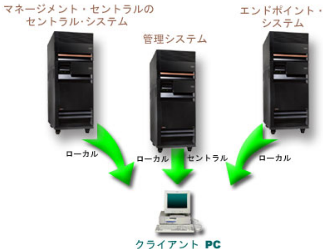
図2. クライアント PC がシステムに接続する場合、接続するシステムからローカル設定が送信される。管理システムに接続する場合には、セントラル設定は管理システムからクライアント PC に送信される。このネットワークでは、アプリケーション管理またはマネージメント・セントラルの機能は変更されない。
