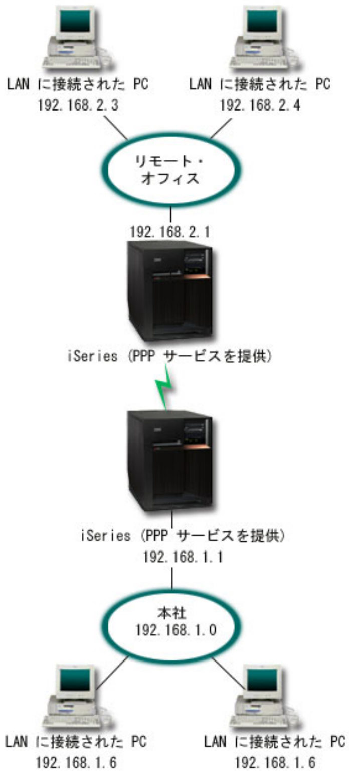
図6. モデムを使用して会社のネットワークとリモート・ネットワークを接続する
