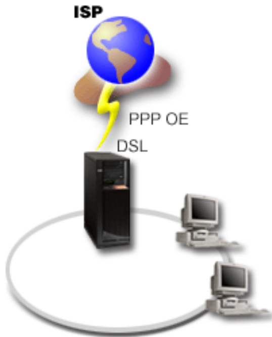
図 3. PPPoE による iSeries サーバーから ISP への接続
