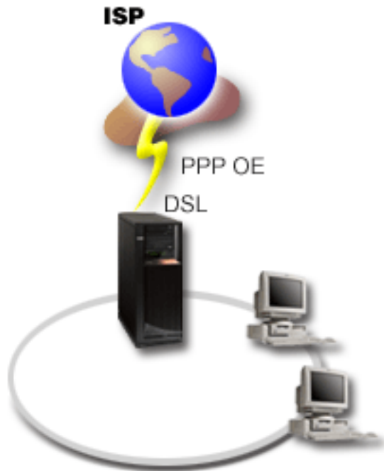
3. ábra: Az iSeries szerver csatlakoztatása PPPoE kapcsolatot használó szolgáltatóhoz
