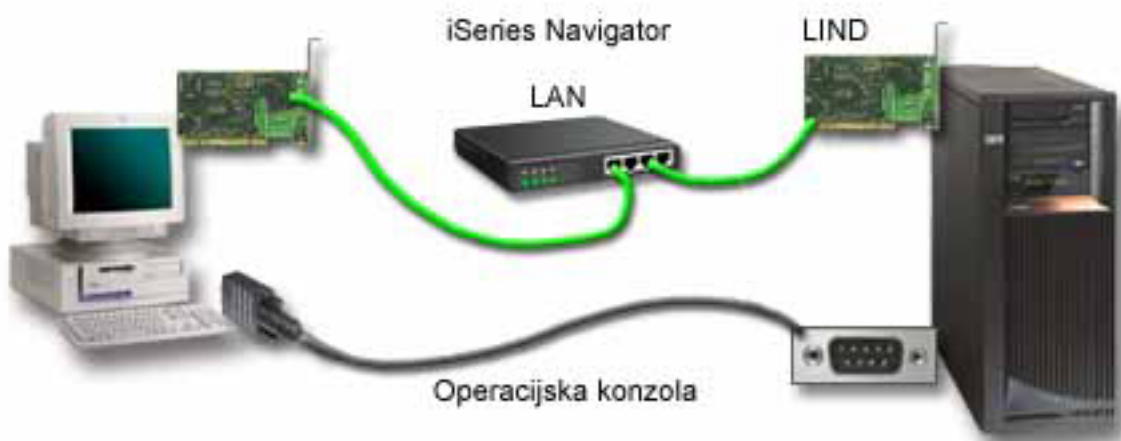
Slika 1. Konfiguracija iSeries Navigatora i Operacijske konzole preko odvojene povezanosti
