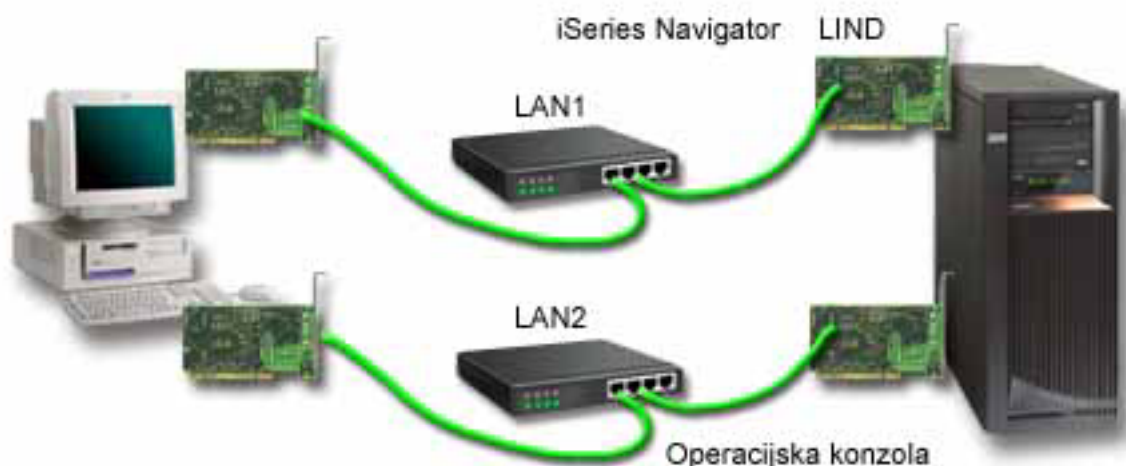
Slika 3. iSeries Navigator i konfiguracija Operacijske konzole na odvojenim mrežama
