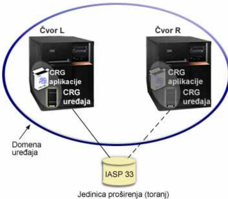
Čvor klastera može pripadati najviše jednoj domeni uređaja. Prije nego što se čvor može dodati u domenu obnavljanja za CRG uređaja, čvor mora prvo biti definiran kao član domene uređaja. Svi čvorovi koji će biti u domeni obnavljanja za CRG uređaja moraju biti u istoj domeni uređaja.
